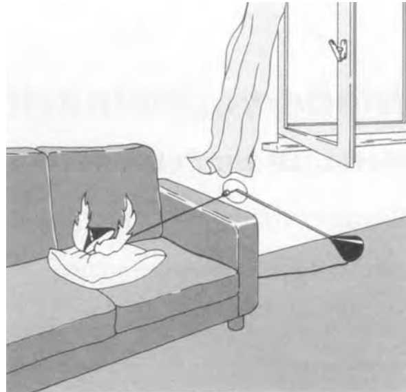
Bild 1: Die unsachgemäße Aufstellung von Standleuchten kann zu einer Brandgefahr werden
